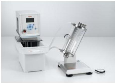
Pour l' expérience P1.8.3.3, la chambre tempérée d'un viscosimètre est reliée à un thermostat à circulation, puis on mesure la viscosité d'un liquide newtonien (par exemple de l'huile d'olive) en fonction de la température.
