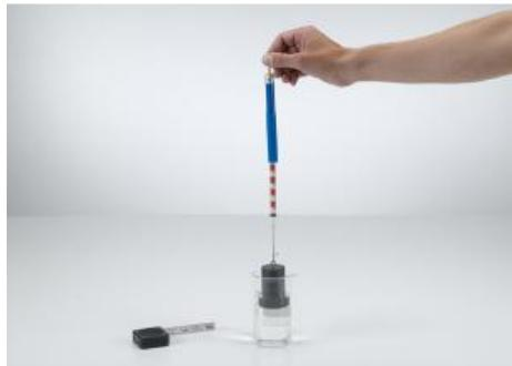
**P1.8.2.2 Mesure de la force portante en fonction de la profondeur d'immersion**
