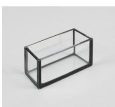
Pour la réalisation d'expériences d'optique avec les liquides telles que, par ex. sur la polarisation, la dispersion.
