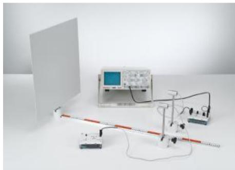
On utilise au cours de l'expérience P1.7.4.2 le principe de l'écho-sonde pour déterminer la vitesse du son dans l'air et également pour déterminer des distances.
