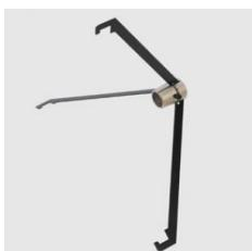
Pour simplifier le montage du transducteur d'ultrasons ( 416000 ) dans le foyer du miroir concave ( 389241 ) lors d'expériences sur les ondes ultrasonores planes. Trépied pliant à fixer sur le miroir concave ( 389241 ).
