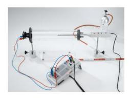
Au cours de l'expérience P1.7.3.4, on détermine la vitesse c du son dans le dioxyde de carbone et dans les gaz rares hélium et néon.
