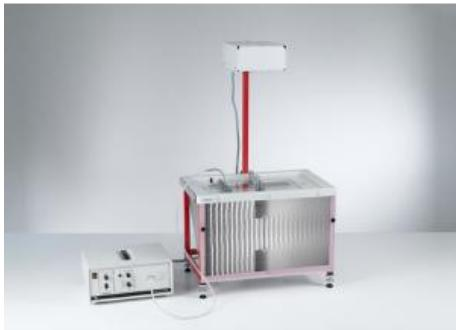
**P1.6.5.3 Diffraction par une fente et un obstacle d'ondes à la surface de l'eau**
