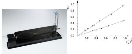
Au cours de l' expérience P1.6.3.1, on détermine, pour une fréquence d'excitation fixée, les longueurs d'onde  $\lambda$  des ondes stationnaires pour différentes longueurs de corde  $s$  et différentes masses de corde  $m$ .
