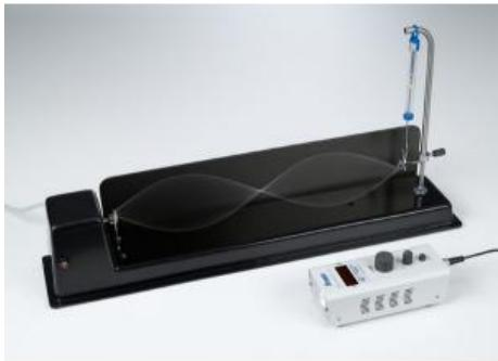
Dans l'expérience P1.6.3.2, on utilise en plus un stroboscope pour le même programme de mesure. Il sert d'une part à déterminer la fréquence d'excitation  $f$  du moteur, d'autre part, à bien visualiser la polarisation circulaire de l'onde lorsque l'onde stationnaire le long de la corde est éclairée par les éclairs du stroboscope, dont la fréquence est proche de la fréquence d'excitation.
