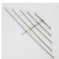
Pour démontrer les phénomènes de résonance avec plusieurs ressorts à lame de longueur différente. Possibilité d'excitation de différents modes d'oscillation. À fixer sur l'oscillateur ( 587 09 ).
