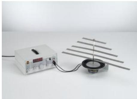
Dans l'expérience P1.6.1.3, on excite le modèle de ressort à lame avec différentes fréquences  $f$  afin d'en étudier la résonance.
