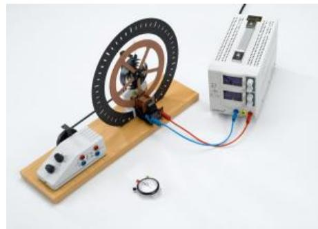
P1.5.3.1 Oscillations de torsion libres - mesure avec le chronomètre manuel
