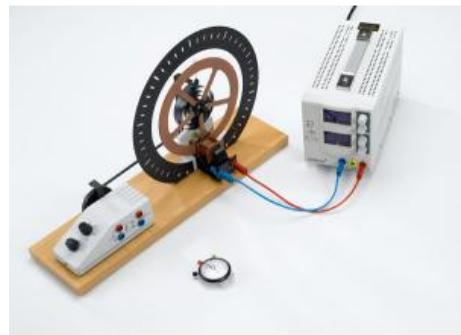
P1.5.3.1 Oscillations de torsion libres - mesure avec le chronomètre manuel
