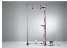
Dans l'expérience P1.4.6.2, on étudie la conservation de l'énergie à l'aide de la roue de Maxwell. Un capteur à ultrasons mesure la position et la vitesse de la roue, ce qui permet de calculer l'énergie cinétique.
