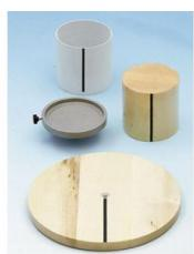
Pour déterminer expérimentalement les moments d'inertie.
