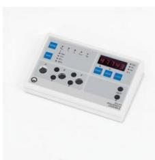
S'utilise en travaux pratiques pour compter les impulsions de tubes compteurs, les taux d'impulsions ou tout autre signal électrique, ainsi que pour mesurer le temps ou la fréquence.
