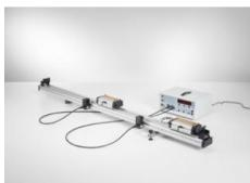
Durant l'expérience P1.3.4.6, on mesure le temps  $t_i$  durant lequel les faisceaux de deux barrières lumineuses sont interrompus par deux mobiles placés sur le rail à chariot, avant ou après un choc élastique ou inélastique.
