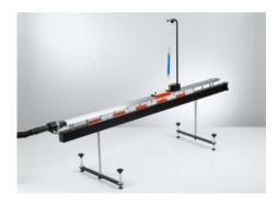
Pour étudier la relation entre réaction et conservation de limpulsion, la force de réaction sur un mobile à réaction est calculée au cours de l'expérience P1.3.4.10 pour différentes sections de sortie dair à laide dun capteur de forces.
