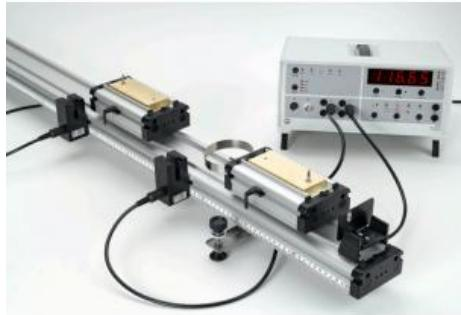
Durant l'expérience P1.3.4.1, on mesure le temps  $t_i$  durant lequel les faisceaux de deux barrières lumineuses sont interrompus par deux mobiles placés sur le rail à chariot, avant ou après un choc élastique ou inélastique. On étudie aussi bien les chocs entre un mobile en mouvement et un objet au repos que ceux entre deux mobiles en mouvement.
