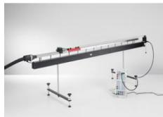
L'expérience P1.3.3.5 consiste à tracer le déplacement, la vitesse et l'accélération d'un mobile qui monte sur un banc à coussin d'air incliné, s'immobilise puis redescend et rebondit sur l'extrémité élastique, faisant ainsi plusieurs va-et-vient.
