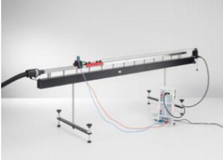
Les mouvements uniformes et uniformément accélérés sur le banc à coussin d'air en position horizontale font l'objet de l'expérience P1.3.3.4.
