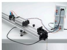
Dans l'expérience P1.3.2.2, on étudie l'évolution du mouvement du chariot sur le rail entraîné par un fil fin. La roue à rayons sert de poulie de renvoi.
