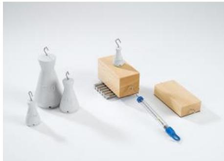
L'expérience P1.2.6.1 consiste à mettre tout d'abord en évidence que la force de frottement statique  $F_H$  et la force de frottement de glissement  $F_G$  ne dépendent pas de la taille de la surface portante et sont proportionnelles à la force d'appui  $G$  du support sur la base du bloc de frottement.
