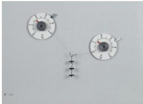
Durant l'expérience P1.2.2.1, une force  $F$  quelconque est compensée par l'élasticité de deux dynamomètres formant les angles  $\alpha_1$  et  $\alpha_2$  avec  $F$ .
