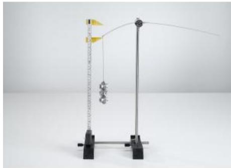
Dans l' expérience P1.2.1.2, on étudie la flexion d'un ressort à lame serré d'un seul côté et soumis à l'action d'une force connue, obtenue en suspendant des masses marquées.
