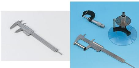
L'expérience P1.1.1.1 consiste à déterminer les dimensions extérieures et intérieures d'un objet à mesurer à l'aide d'un pied à coulisse.
