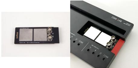
Le scanner de bande est un analyseur de spectre simplifié et est donc utilisé pour l'affichage spectral de signaux dans la gamme de fréquences.
