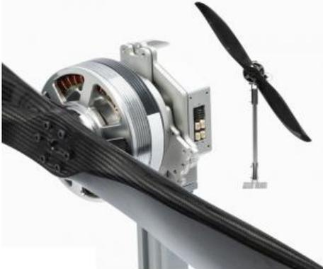
Le banc d'essai Flight Stand 50 vous permet de caractériser et d'évaluer précisément les performances de vos moteurs et hélices en mesurant la poussée, le couple, le régime moteur, le courant, la tension, la température, la vitesse (option), le rendement de l'hélice et le rendement du moteur.
