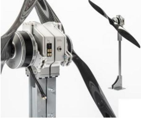
Le banc d'essai Flight Stand 15 vous permet de caractériser et d'évaluer précisément les performances de vos moteurs et hélices en mesurant la poussée, le couple, le régime moteur, le courant, la tension, la température, la vitesse (option), le rendement de l'hélice et le rendement du moteur.
