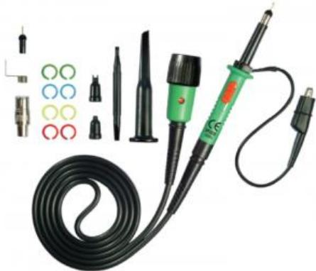
La sonde d'oscilloscope 1:1-1:10 - HP-3250I est une sonde passive haute impédance sélectionnable 1:1-1:10, avec une bande passante de 250 MHz (1:10). Elle est conçue et calibrée pour une utilisation avec des oscilloscopes ayant une impédance d'entrée de 1 M $\Omega$  shuntée de 20 pF. Cependant, elle peut être compensée pour une utilisation avec un oscilloscope ayant une capacité d'entrée de 10 à 30 pF.
