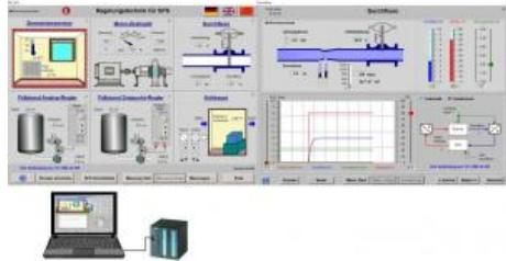
Parties opératives simulées sur PC, proche de la pratique pour programmer des contrôleurs externes (API, Codesys, etc.).
