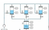
Ce banc dessai pour applications API permet de réaliser des fonctions complexes de commande dans le domaine du génie des procédés, et en particulier des opérations discontinues de dosage et de mélange.
