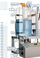
LC2030 Système de régulation de niveau, débit pour API ou régulateur externe, complet,
