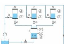
Ce banc dessai pour applications API permet de réaliser des fonctions complexes de commande dans le domaine du génie des procédés, et en particulier des opérations discontinues de dosage et de mélange.
