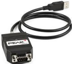
L'adaptateur PCAN-USB FD permet de connecter un ordinateur à un réseau CAN et CAN FD, via IUSB. Une isolation galvanique de 500 V maximum découpe le PC du bus CAN. Sa simplicité d'utilisation et la compacité de son boîtier plastique font de cet adaptateur l'outil parfait pour des applications mobiles.
