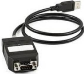
Ladaptateur PCAN-USB FD permet de connecter un ordinateur à un réseau CAN et CAN-FD, via IUSB.
