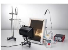
Au cours de l'expérience P2.2.2.1, on détermine la quantité d'énergie Q cédée par unité de temps d'après l'élévation de température de l'eau qui circule puis on estime l'énergie rayonnante absorbée par unité de temps d'après la puissance de la lampe et la distance qui la sépare de l'absorbeur.
