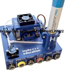
L'HydroFill PRO fournit de l'hydrogène obtenu par électrolyse à partir d'eau distillée.
