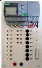
le produit dispose de 12 commutateurs et de 8 LEDs pour la simulation de sortie.
