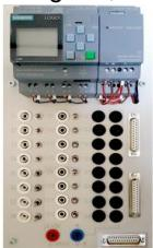
avec 3x DI avec douilles 4 mm de sécurité et 3x interrupteurs
