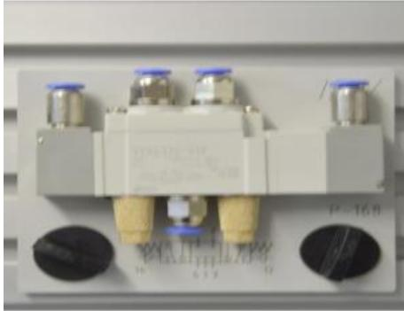
**Distributeur pneumatique 5/3, actionné par air comprimé des deux côtés, médiane centrée sur ressort,**
