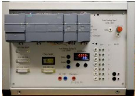
API avec module complémentaire IO-link et Ethernet:
