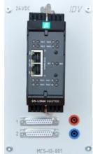
Le module de bus de terrain sert d'interface entre la commande d'un système de bus de terrain PROFINET IO et les appareils IO-Link au niveau du terrain.
