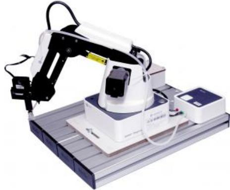
**MCS-640 Robot 2: bras robotisé avec 4 degrés de liberté avec Bluetooth, Wifi et joystick**
