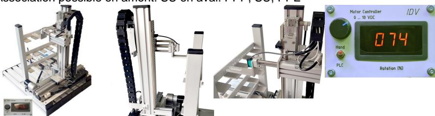
Un axe linéaire électrique avec entraînement par courroie, un axe linéaire par vérin pneumatique pour la hauteur ainsi qu'un vérin pneumatique pour les pièces, retirent les pièces d'une étagère et les transportent dans un autre emplacement.
