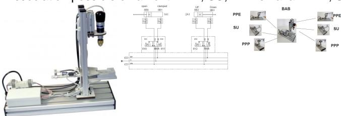
Appareil de perçage électrique à commande pneumatique permettant de transporter, de maintenir et de percer les pièces.
