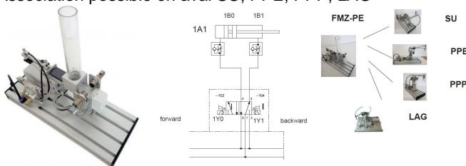
D'un magasin vertical, les pièces à usiner sont séparées et placées sur une plateforme.
