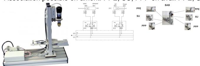
Appareil de perçage électrique à commande pneumatique permettant de transporter, de maintenir et de percer les pièces.
