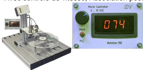
La table rotative à entraînement électrique transporte les pièces dans un cercle et les positionne à un angle de 90 °.
