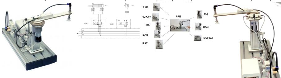
Un moteur à entraînement électrique est soulevé par un vérin à double effet. La pince aspirante.
