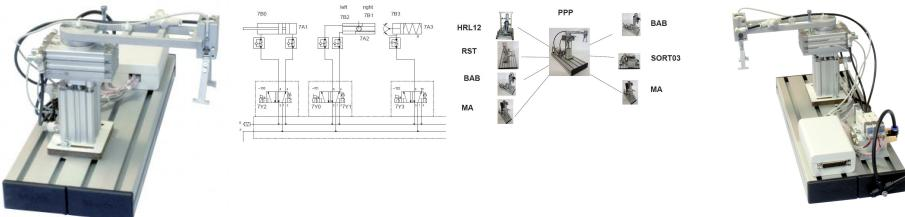
Dispositif de manutention pneumatique avec pièces à usiner prises pneumatiquement, levées et après un mouvement de pivotement jusqu'à max. 180 ° placées à nouveau.
