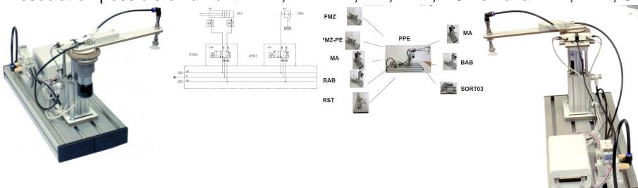
Un moteur à entraînement électrique est soulevé par un vérin à actions alternées.
