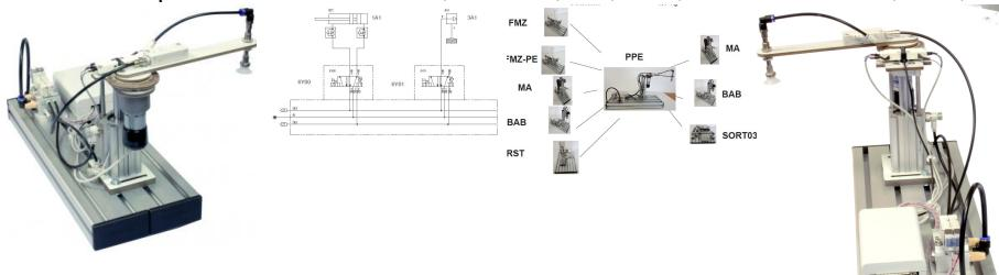
Un moteur à entraînement électrique est soulevé par un vérin à double effet.
