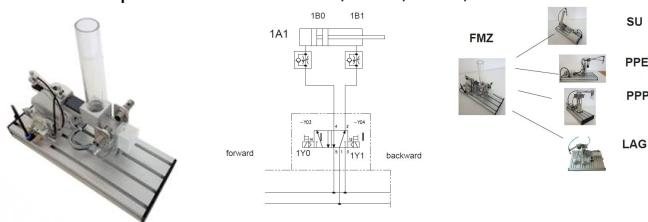
D'un magasin vertical, les pièces à usiner sont placées sur une plateforme.
