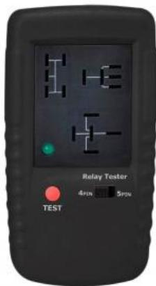
Testez rapidement et avec précision 3 catégories de relais électromécaniques terminaux utilisés sur la plupart des voitures.
