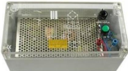
Protection contre les court-circuit et les surcharges, réinitialisation automatique et indication lumineuse du fonctionnement.
