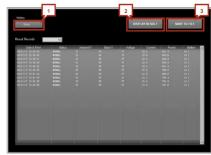
ECO-Marathon Serial Port Monitor est un logiciel développé pour aider l'utilisateur à communiquer avec le système ECO-Marathon, à surveiller et à enregistrer diverses informations, y compris la température ambiante, la température de la pile, la tension de la pile, le courant de la pile, la puissance de la pile et l'état de la pile :
